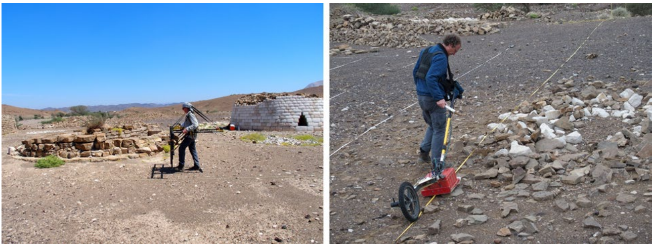
Abb. 21: Geomagnetik- und Bodenradarmessungen in der Nekropole von Bat.
