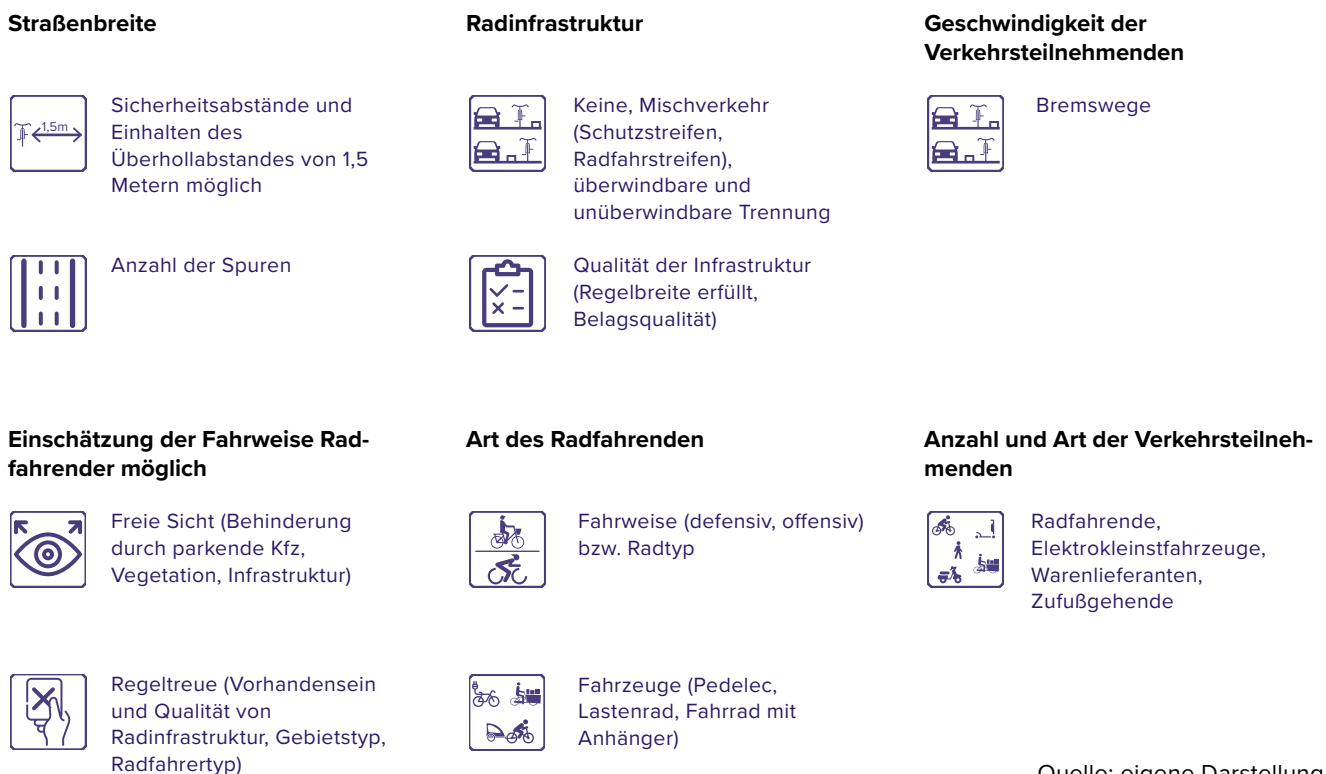
Abbildung 3: Übersicht der Kriterien für die Drivability von automatisierten und vernetzten Fahrzeugen in der Interaktion mit Radfahrenden
